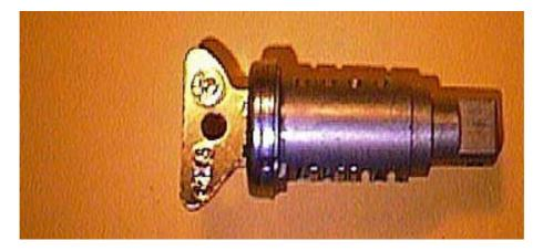
Si on retire la clé quand le canon est en position serrure ouverte, les languettes se déplacent jusqu'à atteindre la paroi du logement du canon. Cela empêche la clé de pouvoir être retirée davantage tant qu'on n'est pas en position fermée.
