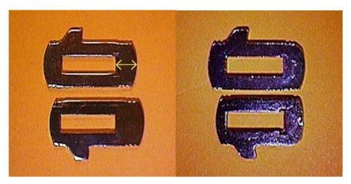
Image de droite : la languette du bas a été retravaillée (dans un étau, avec une lime). La longueur est maintenant la même que celle de la languette supérieure. L'arrondi de la surface extrême a été ajusté à l'arrondi du canon.
