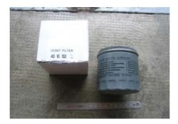
Détails du filtre : Ø 76 mm, H 85 mm, filet ¾ pouce droit, 16 filets par pouce, 6 trous Ø 6.7 mm, polygone 14 pans largeur 74 mm, 337 g, ? dm² de surface de papier, clapet de décharge taré à 1.5 bar [à vérifier] avec crépine, galvanisé à l'extérieur, pas de membrane anti-vidange. Fixation
