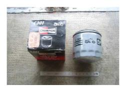
Détails du filtre : Ø 76 mm, H 82.2 mm, filet ¾ pouce droit, 16 filets par pouce, 6 trous Ø 5.9 mm, polygone 14 pans largeur 74 mm, 313 g, x dm² de surface de papier, clapet de décharge taré à 1.5 bar [à vérifier] avec crépine, galvanisé à l'extérieur, pas de membrane anti-vidange. Fixation avec la clé BMW ou un équivalent. Fabriqué en Italie. A tester. 12.45 € chez Louis (réf. 10050400) en 2002.
