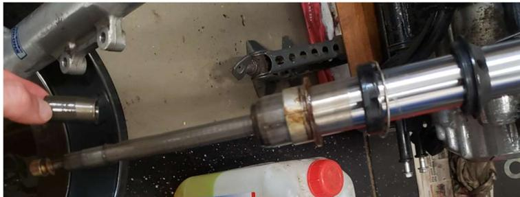
Le détail de la position relative des pièces (notez le cône).
