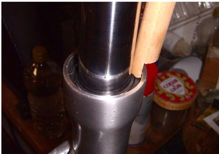
Détail du montage progressif du joint au chasse en hêtre : il appuie à l'extérieur !
