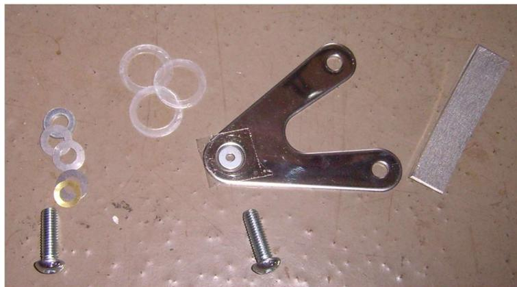
Vis M6-20, rondelles M6 de calage, autres rondelles de 14 mm en PET, Support avec rondelles M3 pour « boucher » le trou de 10 mm et petite ébauche de patte en alu.
