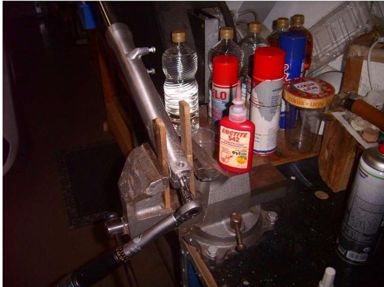
Serrage au couple de la vis de fixation de la pipe d'amortissement (20 Nm),
