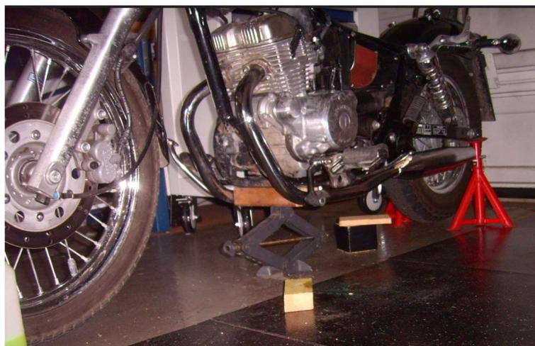
Dans une optique de dépose prochaine des roues, j'ai déposé la bavette arrière : 2 vis H clé de 10 mm et 1 vis H clé de 8 mm. Aucune difficulté à desserrer.
