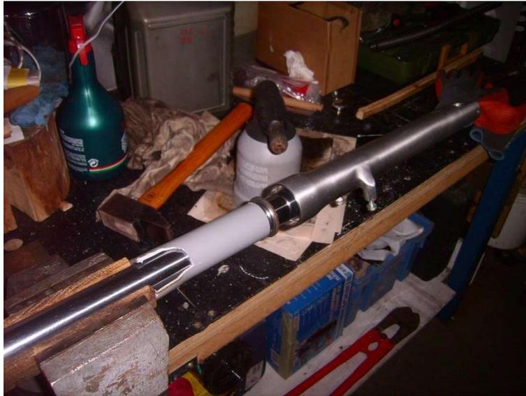
Bloqué à mi-course, j'ai pu finalement asseoir la bague avec ce montage en chauffant très peu la zone de logement de la bague. Tube dans l'étau, c'est le fourreau qui m'a servi de masse d'inertie. Notez le tube PVC cassé à force de taper dessus dans la tentative précédente sans que la bague ne vienne en butée dans son logement.
