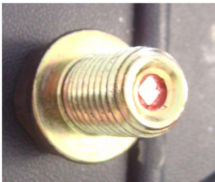
L'aimant a une diagonale de 4,1 mm et j'ai percé à 4,5 mm.
