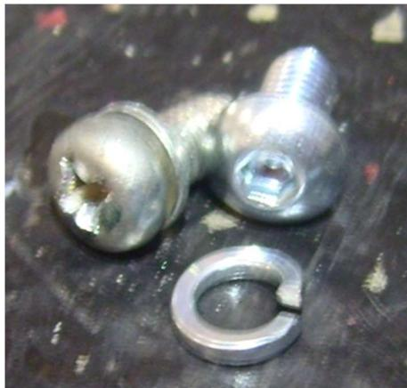
J'ai trouvé une vis hexacave M4-8 (clé Allen de 2 mm) au boulot, mais à tête arrondie qui est plus jolie, plus légère et remplace visuellement au mieux la vis cruciforme en place. Il y a une rondelle frein sous la vis et je l'ai remplacé par une autre, que j'espère moins fatiguée. Je l'ai monté le soir venu. Il ne faut pas serrer trop fort pour ne pas foirer le filet du support en tôle fine, surtout qu'avec une « vraie » clé, l'effort excessif est vite atteint.
