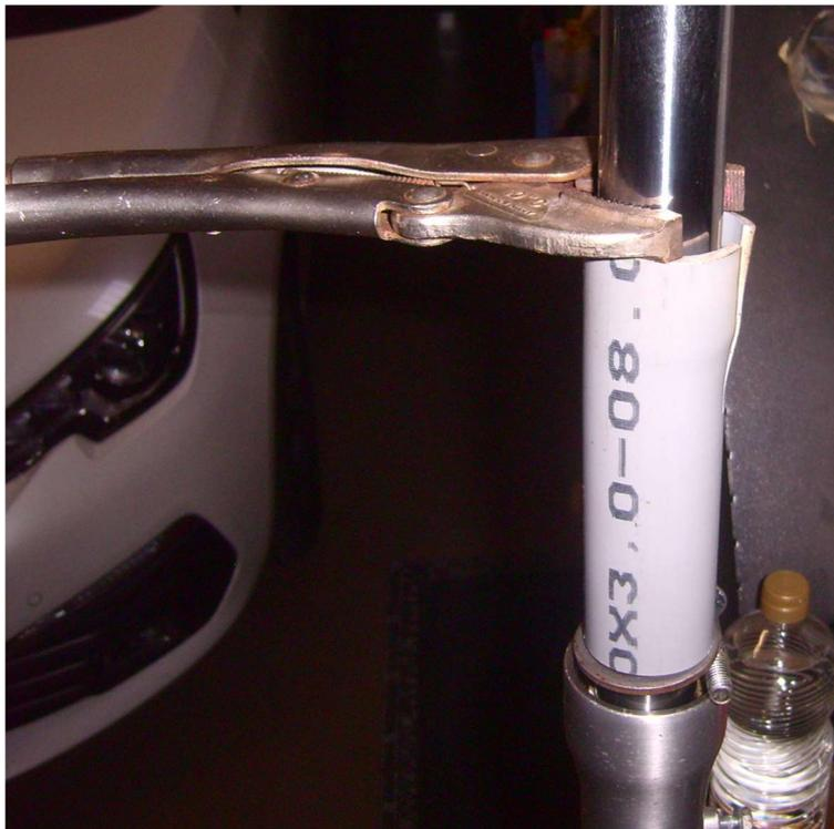
Montage de la bague antifriction du fourreau : la vis entre fourreau
